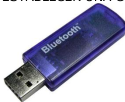
FIG. 3. DISPOSITIVO USB QUE PERMITE ESTABLECER UNA CONEXIÓN TIPO BLUETOOTH
